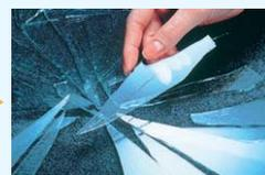
板ガラスは、破片が大きく鋭利であるため、大きなケガにつながる恐れがあります。強化ガラスは万一割れても破片が粒状になるので、人体衝突の際に大ケガを防ぐことができます。
